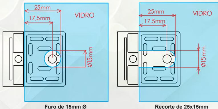
\*A peça acompanha 1 par de borrachas plásticas que pode ser alternada, invertendo os encaixes, adaptando-se para vidro de 10mm ou vidro de 12mm.
