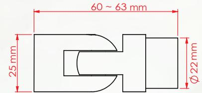
Conexão T&M Angular Para Tubo
